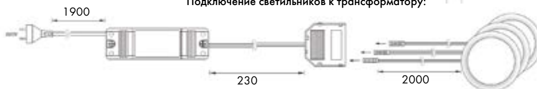
Подключение светильников к трансформатору:
